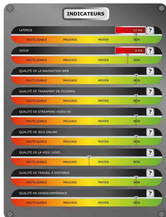
Figure 1 : Testeur INC, estimation de la qualité prévisible d'un éventail de services.
